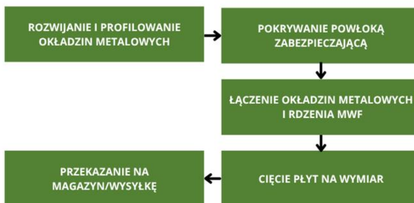
Rysunek 5.2: Schemat procesu produkcyjnego płyt warstwowych z rdzeniem MWF
